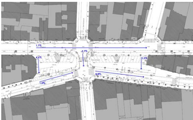
Nivellement de la place, avant et après travaux
